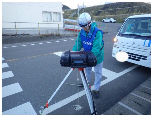
可搬型エリアモニタ設置
