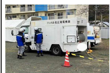
送配電の低圧発電機車
