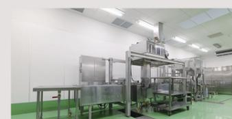
油層内のヒーターで直接加熱するため、熱効率が高く温度制御性が良いため、油温度の過上昇を防ぎ、油の劣化(酸化)を抑制できます。
