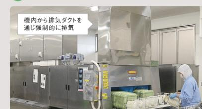
強力な洗浄水の噴射で食器間に隙間を生み出し、隅々まで洗浄できます。
