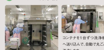
コンテナを1台ずつ洗浄機へ送り込んで、自動で丸ごと洗浄します。
