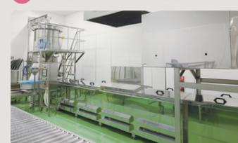
米庫から洗米機・浸漬機と連動し、洗米から炊飯まで自動で完了することができます。
