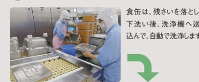
食缶は、残さを落として下洗いをし、洗浄機へ送り込んで、自動で洗浄します。
