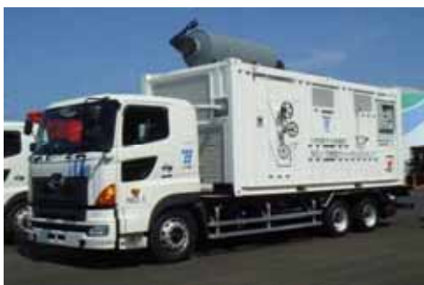
可搬型ディーゼル注入ポンプ
