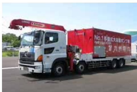
移動式大容量ポンプ車
