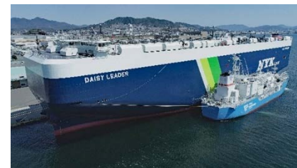
LNGを燃料とする船舶(写真奥)に、LNG燃料を供給するバンカリング船(写真前)
