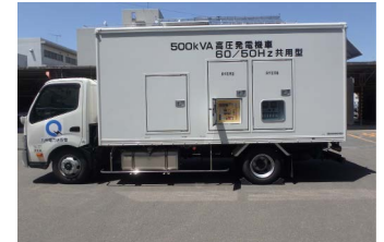
高圧発電機車
