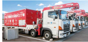
移動式大容量ポンプ車
