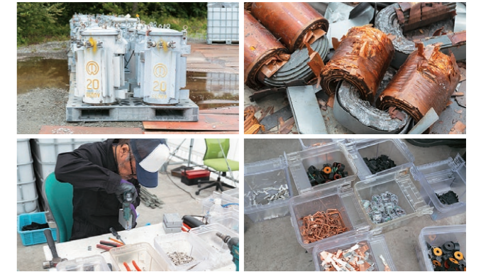
左上:電柱の上部に設置され、家庭用の配電に必要な不可欠な「柱上変圧器」。右上:変圧器の内部には、紙に包まれた貴重な銅線がぎっしり。左下:運び込まれたスマートメーターなどは、部品一つ一つを確認しながら慎重に分解されます。右下:素材ごとに分別すれば、リサイクルもより有効に。
