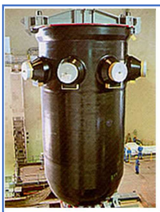
玄海3号機の原子炉容器
