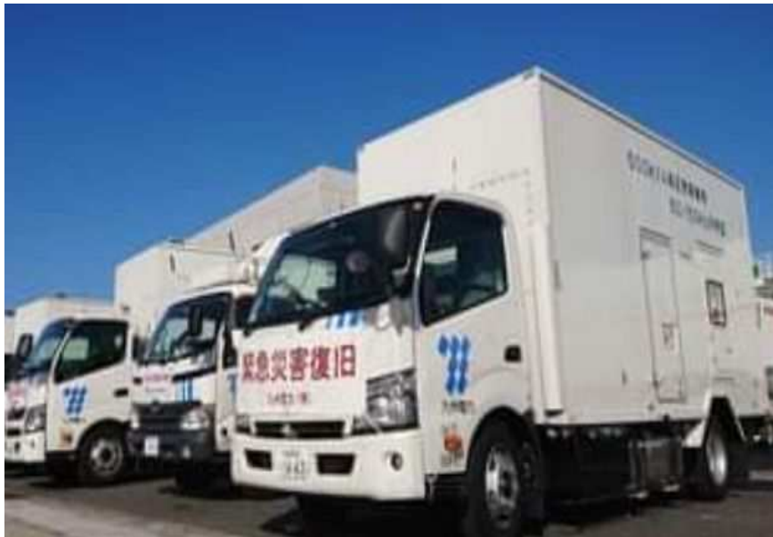
仕様統一された高圧発電機車の導入
