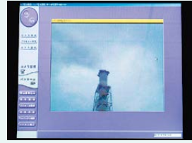
排煙監視モニター
