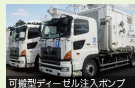
可搬型ディーゼル注入ポンプ
