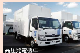
高圧発電機車
