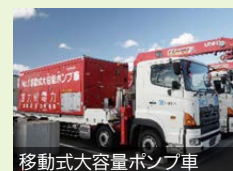
移動式大容量ポンプ車
