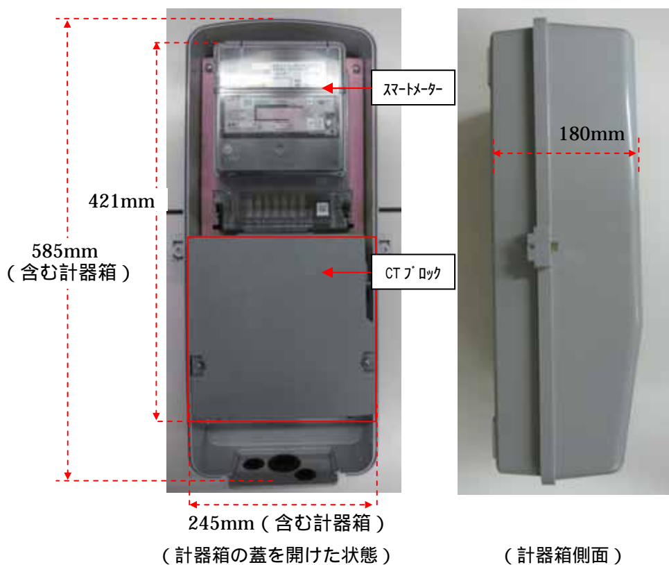
〔スマートメーターと CT ブロックの組合せ〕
