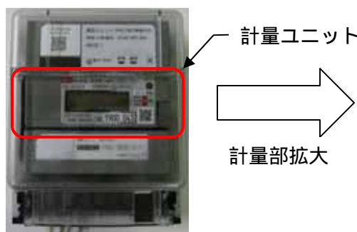
〔スマートメーター〕
