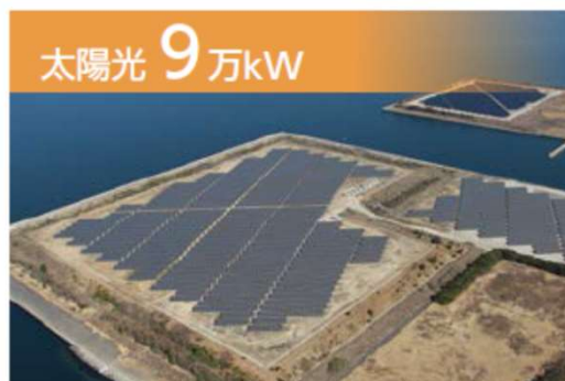
太陽光 9万kW 大村メガソーラー第1~4発電所(長崎県) 設備容量: 17,480kW(パネル容量20,350kW) 操業開始: 2013年3月
